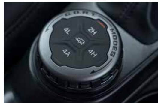
► Med det här bekväma vridreglaget kan inställning av hög- och lågväxel lätt ändras.
