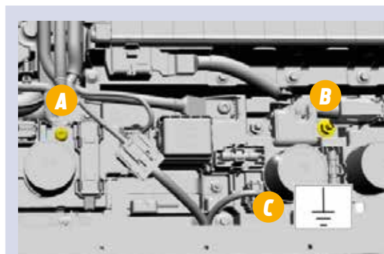
Fastställande av att spänningen är bortkopplad genom mätning i punkterna A mot B, A mot C och B mot C (här på exemplet Mustang Mach-E) ingår i kursen "Högspänningsteknik för högspänningsspecialister".
