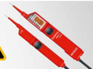
Fastställande av att spänningen är bortkopplad genom mätning i punkterna A mot B, A mot C och B mot C (här på exemplet Mustang Mach-E) ingår i kursen "Högspänningsteknik för högspänningsspecialister".
