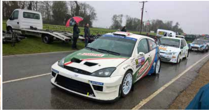
▲ The Ford Focus RS WRC 03 var den största utvecklingen under första generationens Focus WRC:s livslängd. Den hade en stor bakflygel samt frontspoiler för bättre aerodynamisk prestanda.
