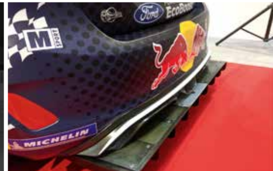
▲ Den nuvarande generationen WRC-bilar har avancerad aerodynamik, däribland en stor bakre diffusor.
