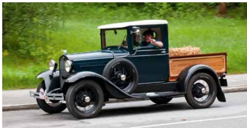
Fords lastbilsmodell TT hade ett förstärkt chassi, men de flesta av de mekaniska delarna var samma som i bilversionen Model T.
