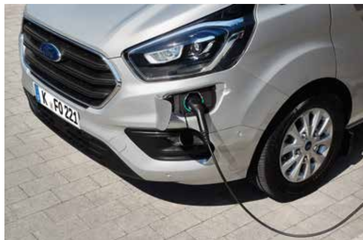
I Ford Tourneo Custom Hybrid används seriell hybriddrivenhet.
