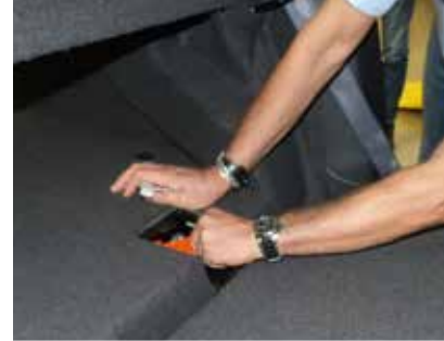
► En person med högvolt behörighet drar i servicebrytaren för att göra fordonet spänningslöst.
