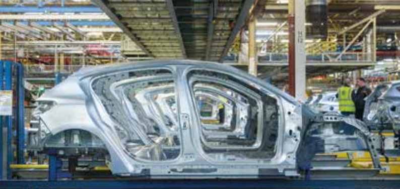
▲ En olackerad råkaross till nya Ford Focus i väntan på nästa behandling i produktionen.
