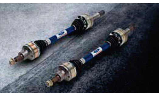
Framförallt på en effektoptimerad Ford Mustang är det lämpligt att även montera förstärkta drivaxlar.
