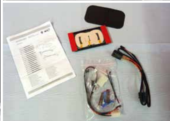
▲ När universalsatsen ska installeras sätts induktionsplattan med sändarspolar dit med hjälp av två klisterremmar, till exempel under förvaringsfacket i nya Ford Ka+. FINIS: 2102307
