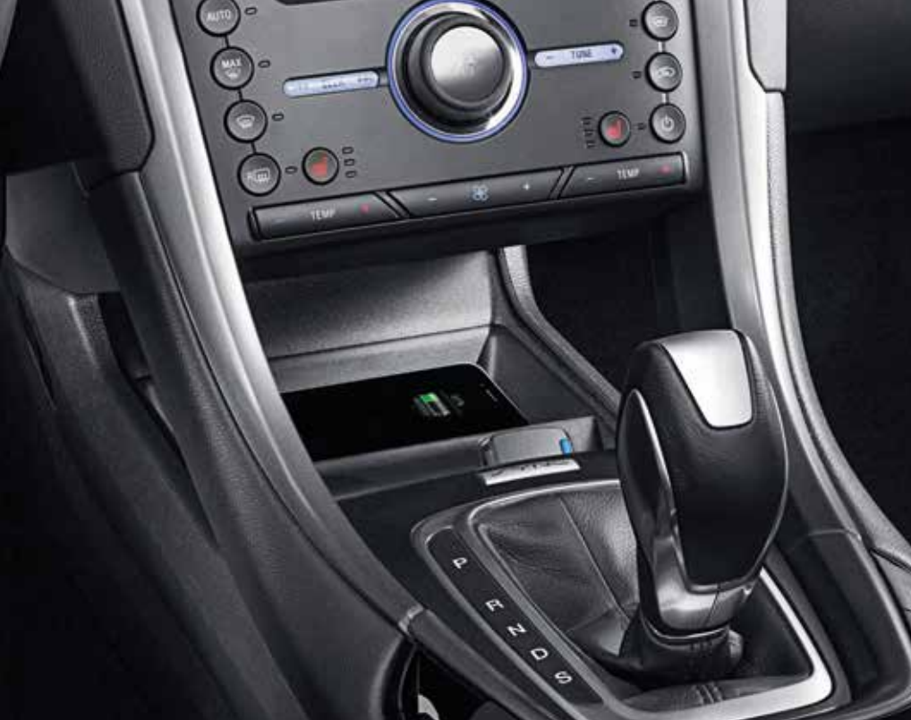
▲ När universalsatsen ska installeras sätts induktionsplattan med sändarspolar dit med hjälp av två klisterremmar, till exempel under förvaringsfacket i nya Ford Ka+. FINIS: 2102307
