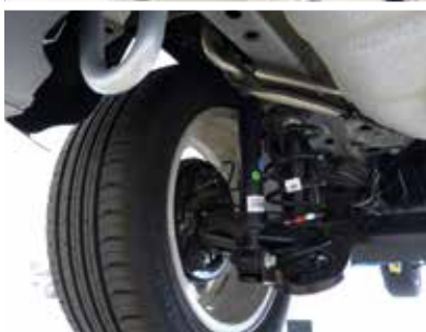
▲ Bakaxel: halvstel axel med spiralfjädrar och vertikala stötdämpare.
