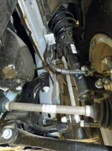
▲ Framaxel: klassiska MacPherson-fjäderben, trekantslänkkarm, krängningshämmare med kopplingsstänger samt ventilerade bromsskivor.
