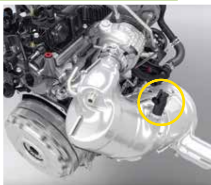
▲ Ford Transit och Transit/Tourneo Custom med dieselmotorn 2.0L EcoBlue är utrustade med SCR-teknik för att minska kväveoxidnivåerna.
