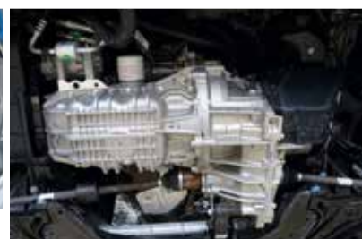
▲ 1,2-litersmotorn Duratec-16V Ti-VCT finns bara i kombination med 5-växlad manuell växellåda B5 (iB5).
